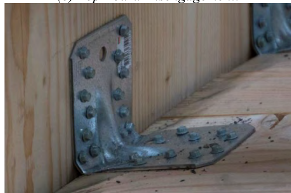
(d) Wood Crushing & Fastener Pullout.
