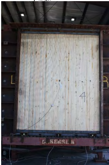
(d) Test 4: 2x6 NLT \mu_{\text{target}} = 0.75 .
