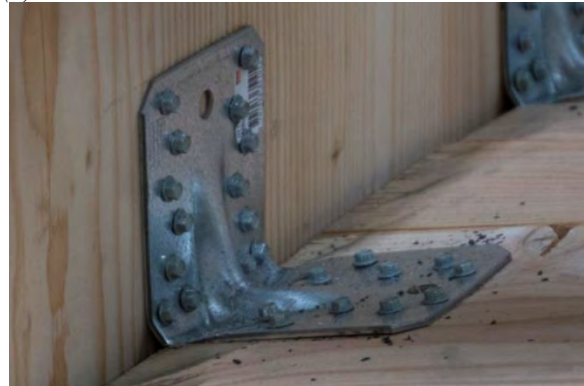
(d) SST Bracket Deformation (L4x4 Similar).
